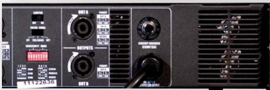
Rückseite der SP-Serie Endstufen mit Dip-Schalter zur Aktivierung der Filter
