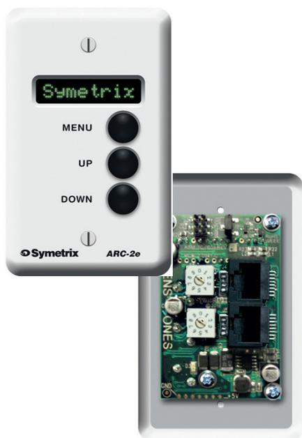
**ARC-2e** ist eine menügeführte Fernbedienung für Symetrix DSPs. Mit bis zu 24 Menüs greifen Sie auf die gesamte Power Ihres DSP Prozessors zu, die einfache Steuerfunktionen oder komplexe Logik-basierende Ereignisse kontrollieren kann. Room Combining, Quellenwahl, Presetabruf oder Laut-
