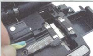
Nun wird mit Hilfe des Glasfaser Spaltbeils und dem am Spaltbeil befindlichen Maßband die freiliegende Glasfaser auf einer Länge von 28 mm gekürzt.
