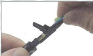
Jetzt wird die gekürzte Glasfaser von hinten in den Steckverbinder gesteckt bis ein kleiner Bogen entsteht und sich die durch den VFL erzeugte Lichtstärke im Steckverbinder-Kontrollfenster reduziert bzw. vollständig erlischt.
