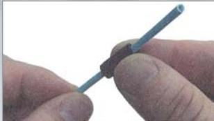
Rückwertige Verschlussmuffe vom Stecker abschrauben und über das zu konfektionierende Kabel stülpen. Bei 2 mm dickem Glasfaserkabel die beiliegende Tülle nach dem Überstülpen der Verschlussmuffe zusätzlich über das Kabel ziehen.
