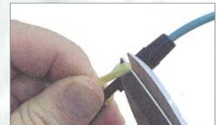
Schließlich werden die herausschauenden Garne mit Hilfe der Kevlar-Schere bündig abgetrennt und die Steckerhülle wieder auf den Stecker montiert. Fertig!
