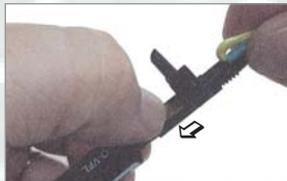
Nun wird der Aktivator-Schlitten in Richtung des VFL geschoben (in Pfeilrichtung) und der Steckverbinder kann nun vom VFL abgenommen werden. Nach der Prüfung ob sich die Glasfaser gerade im Steckverbinder befindet, wird das Gelenkstück geschlossen und die Verschlussmuffe auf den Stecker geschraubt so dass die Kevlar-Garne zwischen Stecker und Muffe heraus schauen und somit fest mit dem Steckverbinder verbunden sind.
