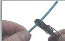
Mit einer Abisolierzange den Mantel vom Kabel in einer Länge von ca. 5 cm entfernen.
