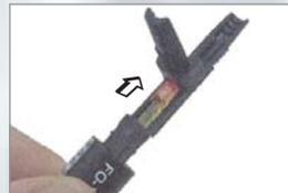
Die Schutzkappe und Hülle vom Steckverbinder abziehen und auf den VFL (Visual Fault Locator/ Optischer Fehler Anzeiger) stecken. Bitte darauf achten, dass sich der Aktivator-Schlitten des Steckverbinders in der Position „Open“ befindet (Schieber mit dem aufgedrucktem Pfeil befindet sich nicht in Richtung des VFL). Nun wird das Gelenkstück am Ende des Stecker geöffnet auf dem sich zuvor die Verschlussmuffe befand.
